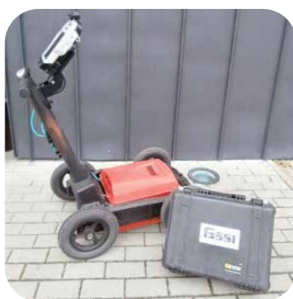
Radar géophysique UtilityScan DF équipé de deux antennes couplées 300MHz-800MHz.
