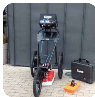
Radar géophysique UtilityScan LT équipé de plusieurs antennes individuelles 200MHz, 400MHz, 900MHz, 1GHz et 2,6 GHz et SIR4000.
