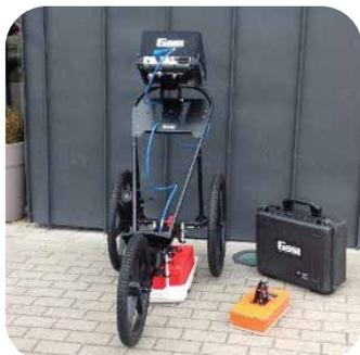
Un radar géophysique Utility Scan DT 200MHz-900MHz.
